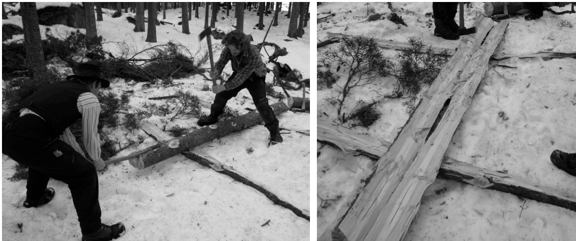
Timmermännen Olof Andersson och K-M Melin klyver en fereskate genom att hugga växelvis. På samma vis tillverkade vi bokkäppar till Bondrumsgården. Foto Ingmar Melin.
