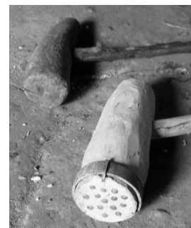
Överst lerklubba från Göinge med skaft av en. Underst lerklubba förvarad i Blåherremölla förstärkt med järnring och spik.
